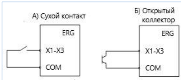
Рисунок 8 – Подключение дискретного входа X1
