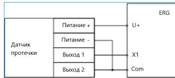
Рисунок 9 – Подключение внешнего датчика протечки
