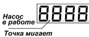
Рисунок 11 – Индикация работы насоса
