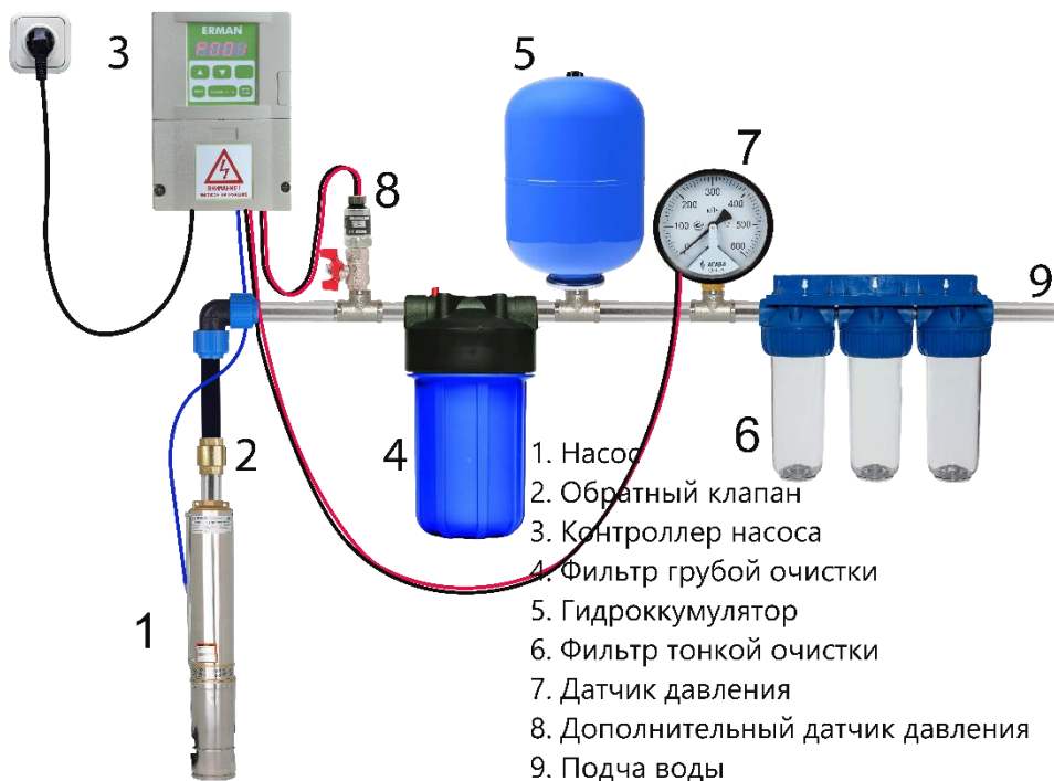
Рисунок 1 – Схема автоматизации системы водоснабжения
